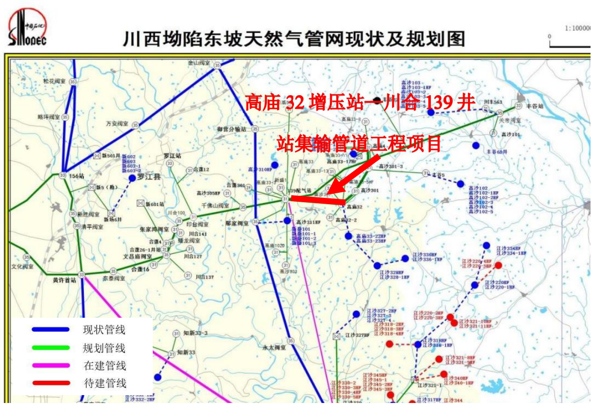
图 1.1-1 建设项目与区域现有站场及管网关系示意图
