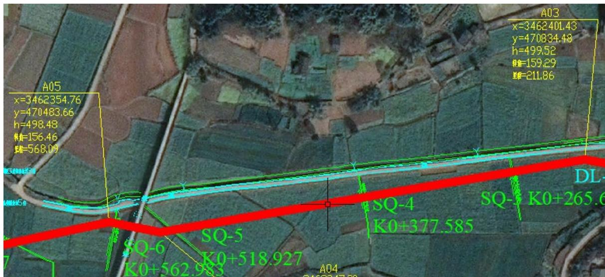
图 3.1-1 A03-A05 与道路并行段管道走向示意图
