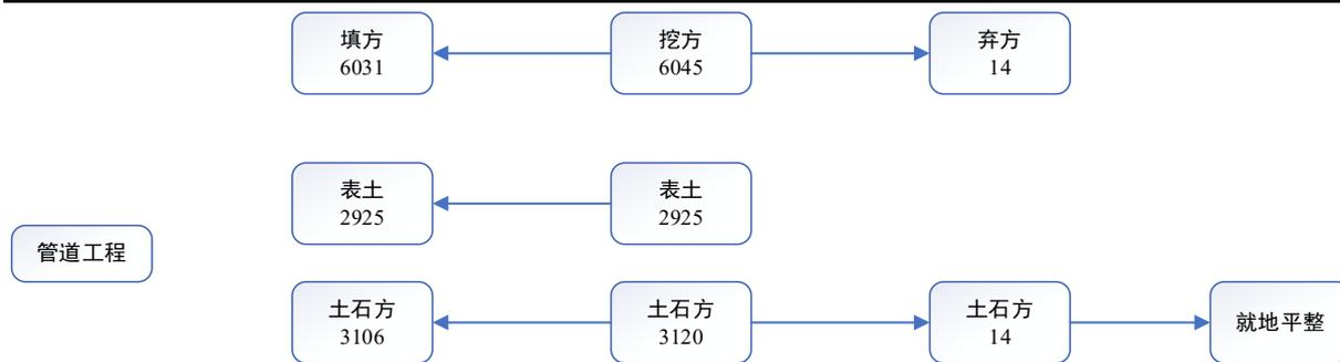
图 3.2-3 拟建项目土石方平衡图
